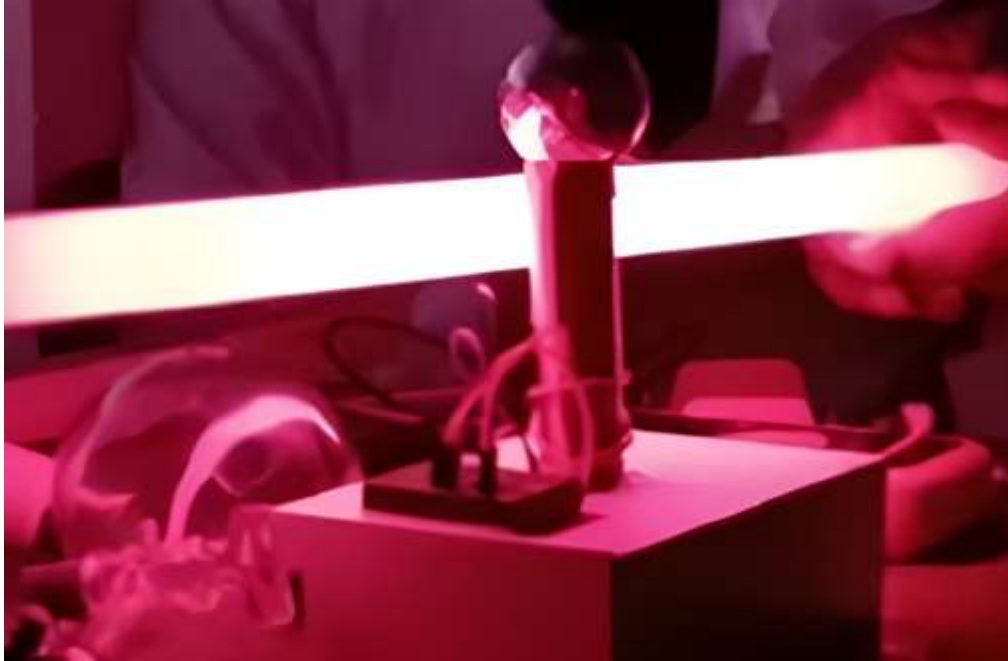
Fig. 4. Obtención de plasma frío a partir de un tubo ionizado
