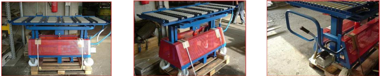
Figura 6. Carro de movilización punzones. Gapedue.
