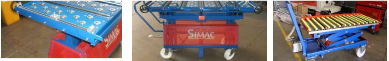
Figura 8. Carros para cambiar punzones Simac
