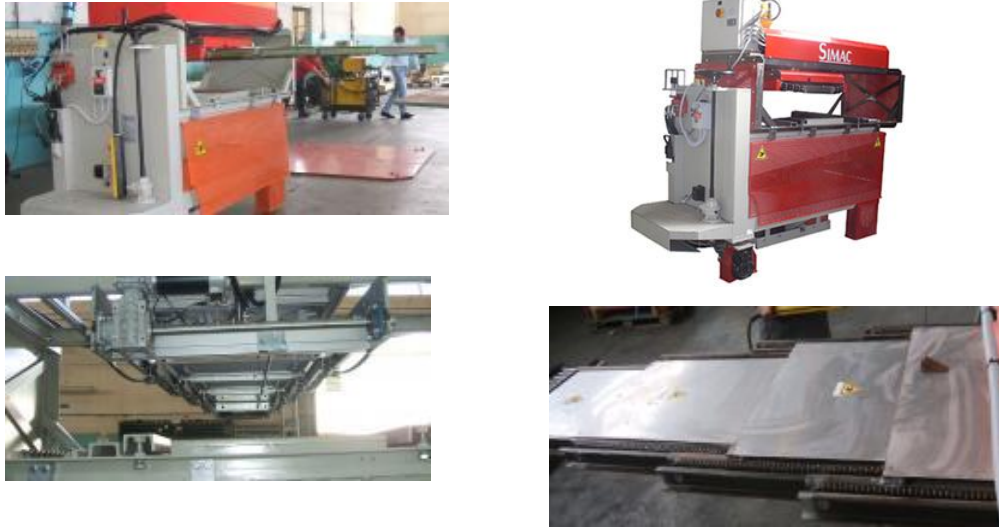
Figura 9. Carro semiautomático para cambio de punzones. Mpm Simac
