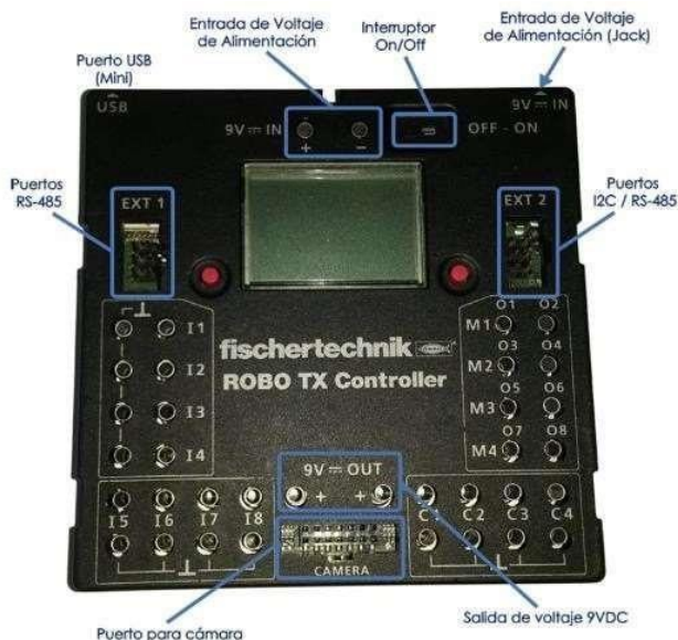
Ilustración 7 Alimentación de controlador TX
