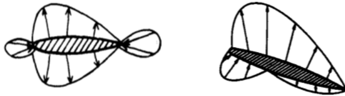
Figura 7. Distribución de presiones sin y con ángulo de ataque en un perfil aerodinámico.
