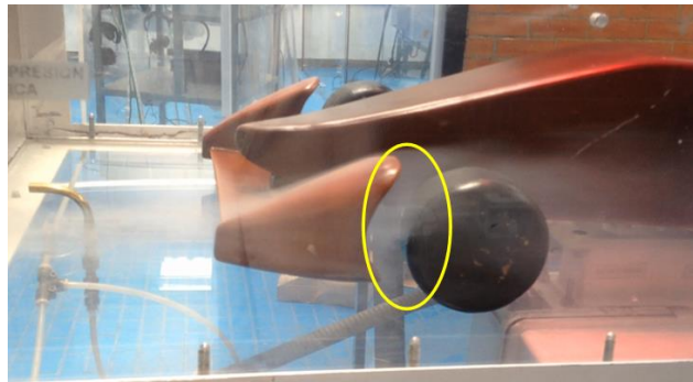
Figura 32. Comportamiento del flujo del aire en alerón de un elemento
