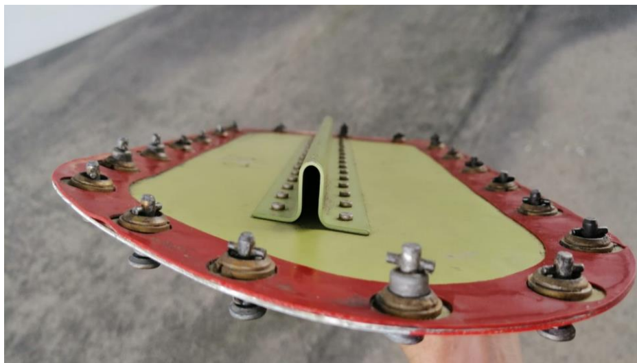
Figura 7. Tapa de inspección vista frontal. Fuente: Propia del autor.
