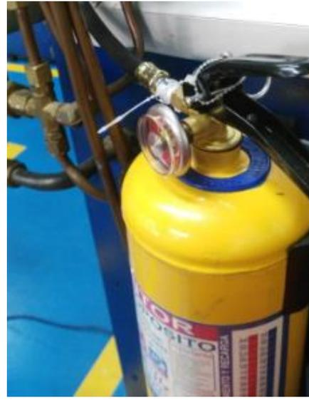
Ilustración 19. Instalación extintor y mangueras; Instalación Racores Extintor (Elaboración propia)
