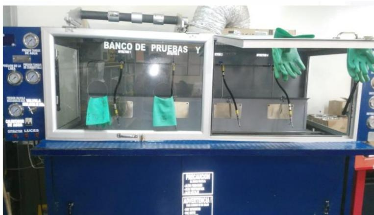
Ilustración 10 Banco de Lavado de Inyectores (Manual). (Elaboración propia)
