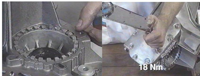
De esta forma ya está armado, Haga lo correspondiente para volver a colocar en el vehículo teniendo en cuenta las presiones de ajuste específicas.
