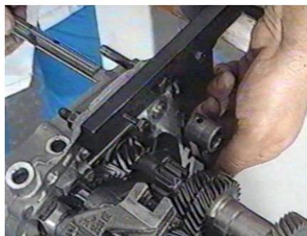
**18** Con la herramienta especial y la ayuda de una pinza quite el anillo reten del eje de salida, tren de engranajes, ejes de las horquillas y extráigalos todos juntos.
