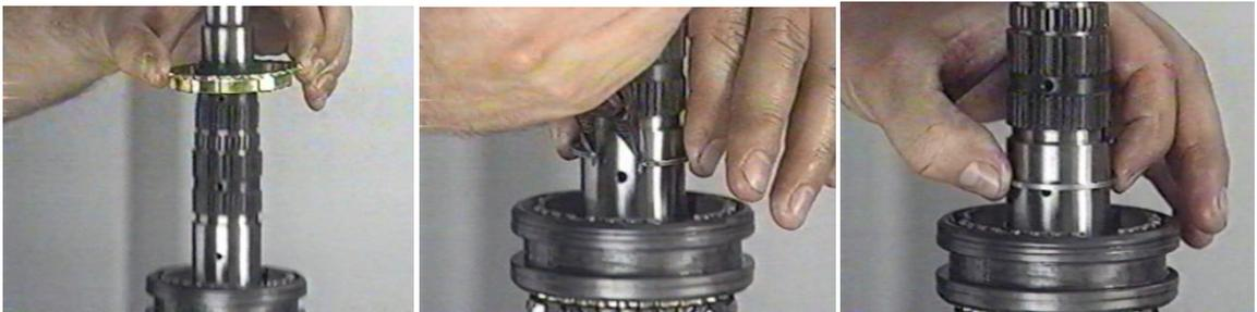
**7** Finalmente quite los demás componentes en la prensa y note que el piñón del diferencial es pieza integrante del eje de salida.
