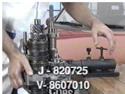
**7** Caliente los tornillos de la horquilla de la quinta velocidad a una temperatura de 80 Celsius y extráigalos, junto con la horquilla.
