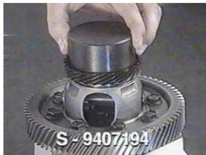
**8** Coloque la caja de satélites en la carcasa, junto con el manguito de regulaje.
