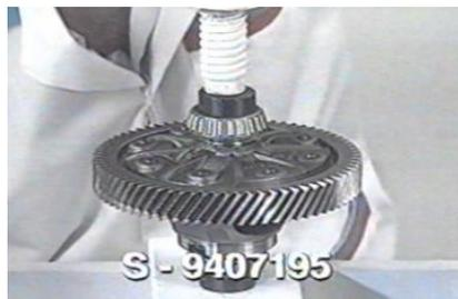
**7** Coloque un nuevo engranaje accionador del velocímetro con ayuda de la herramienta especial.
