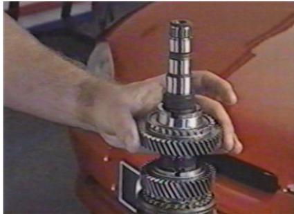
**7** Instale los anillos tambores de sincronización juntamente con el anillo intermedio
