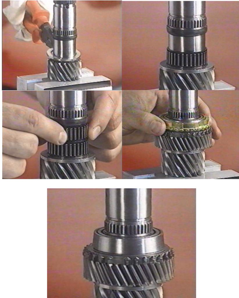
**2** Caliente el cubo a 100 grados Celsius y colóquelo, observando que el lado cónico de la ranura del manguito quede en dirección al piñón. Instale la arandela de tope y un nuevo anillo reten.
