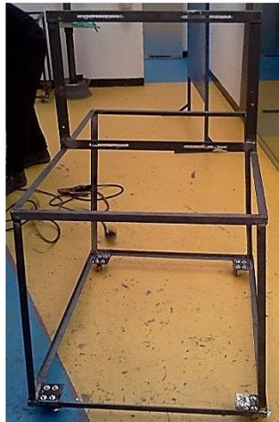
2. En este marco se asegura la caja mecánica para su posterior prueba de funcionamiento, consta de unos rieles que permiten variar el ancho para que así pueda adaptarse a varios tipos de cajas mecánicas.
