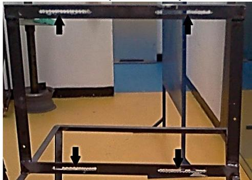
3. Estas laminas son las encargadas de sostener la caja mecánica al marco, también constan de unos rieles que permiten variar su altura para un ajuste optimo, las láminas se colocan un extremo en el riel del marco del banco probador y su otro extremo en los orificios de los tornillos que tiene la carcasa de la caja mecánica.
