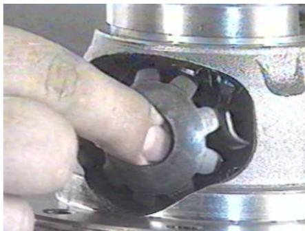
**2** Arme el eje del porta satélites y coloque la traba del eje.
