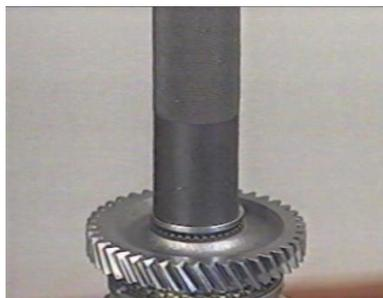
**13** Coloque en anillo reten e instale el cojinete con ayuda de la prensa y de un tubo adecuado. Después de haber calentado la cuna del engranaje de la quinta colóquela en el eje con ayuda de la prensa.
