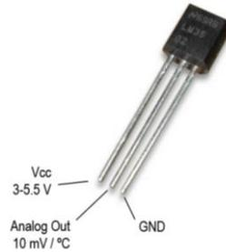
*Ilustración 7 Sensor de Temperatura
