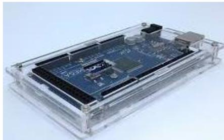
*Ilustración 4 Arduino Mega
