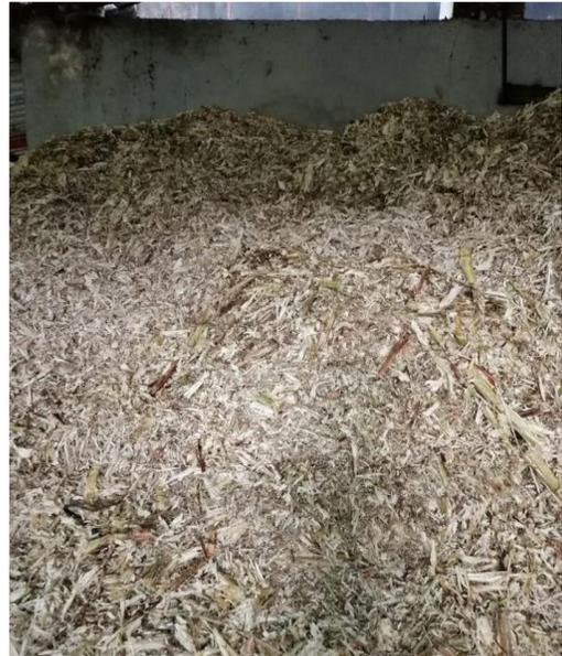
*Nota.* Silos de bagazo que se deja secar para luego utilizarlo como combustible en la cocción del jugo de caña.
