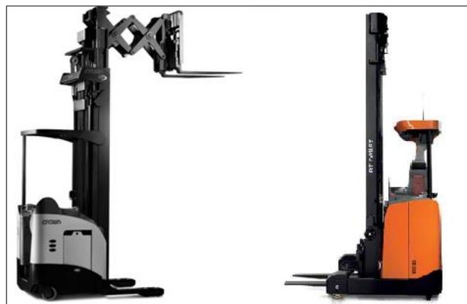
**Foto 1. Montacargas eléctricos pasillo angosto. Reach (Izq) / Retráctil (Der).**
