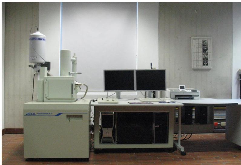
**Figura 16. Microscopio SEM utilizado en caracterización de recubrimientos.
