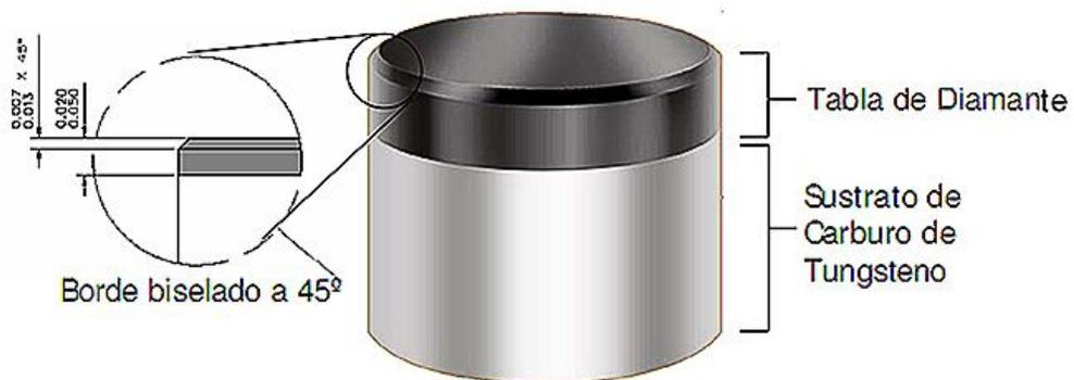
Figura 32. CORTADOR PDC.
