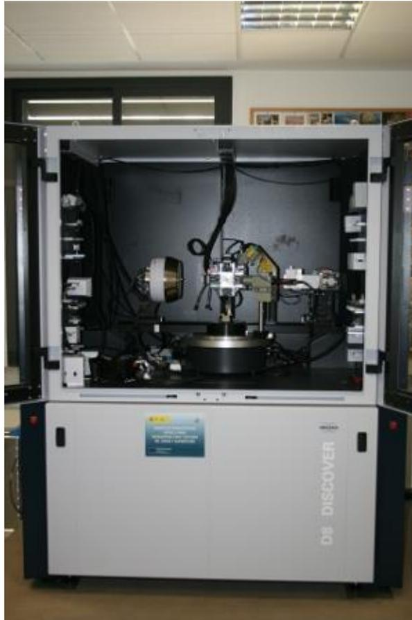
Figura 37. Difractómetro utilizado en la caracterización estructuras cristalinas de los recubrimientos
