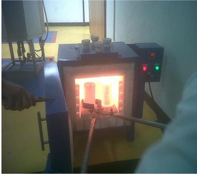
Figura 35. Horno utilizado en el tratamiento TRD.
