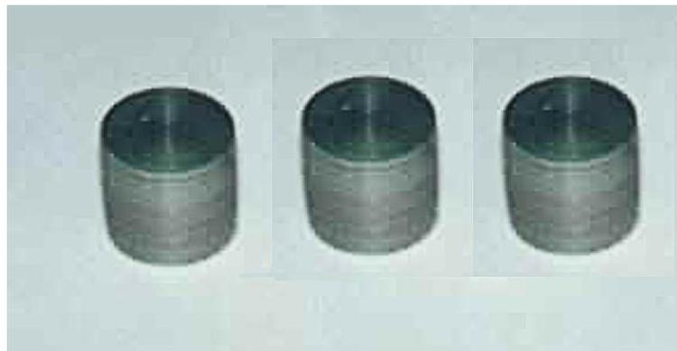
Figura 33. Probetas de acero AISI D2 utilizadas en esta investigación.
