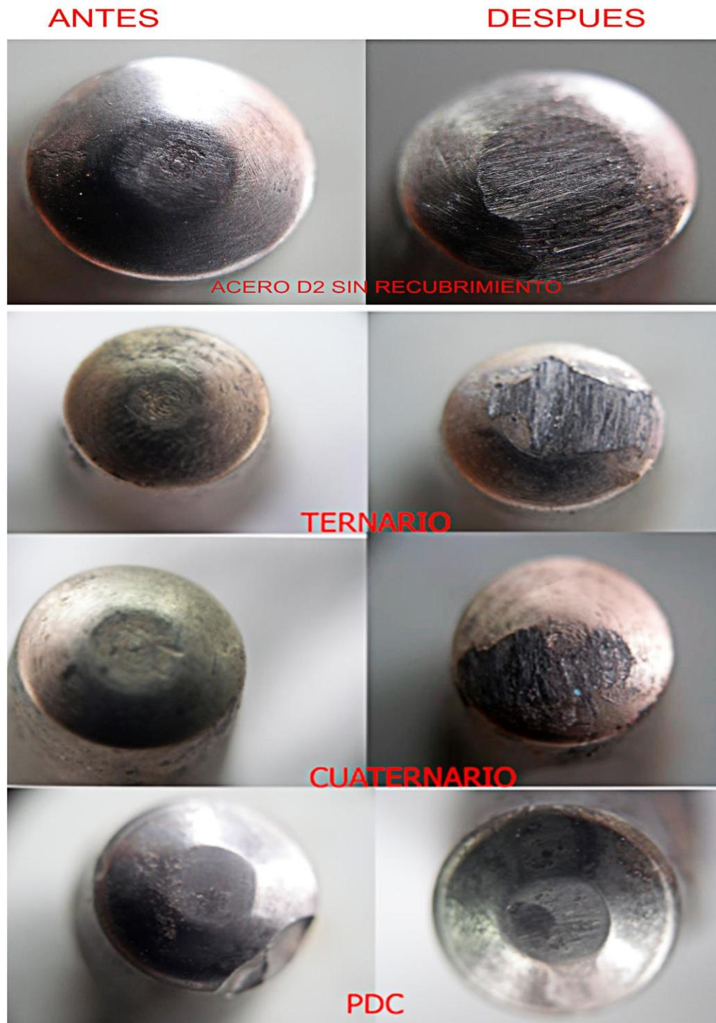
Figura 53. Comparación antes y después de hacer la prueba de desgaste
