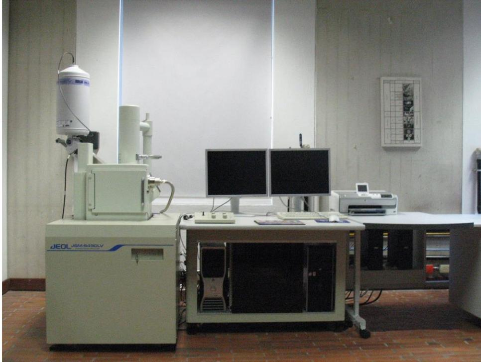
Figura 36. Microscopio utilizado en la caracterización de morfología y composición química de los recubrimientos obtenidos.
