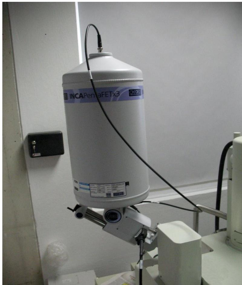
**Figura 38. Microscopio utilizado en la caracterización de la composición química de los recubrimientos obtenidos.**
