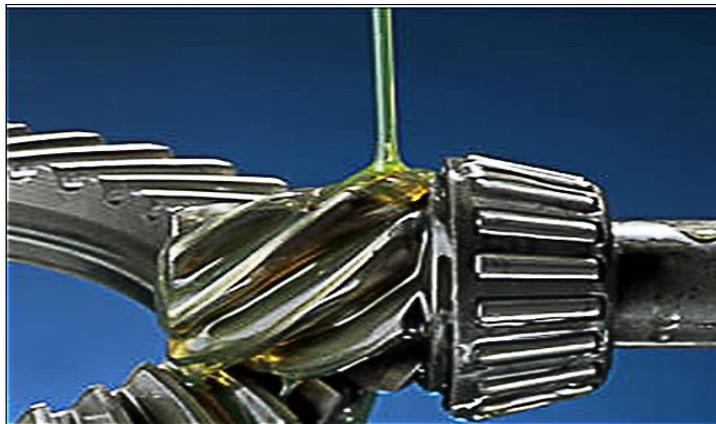
Figura 19. Contacto entre dos superficies del engranaje.
