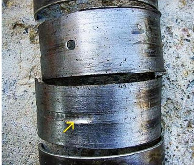
Figura 21. Desgaste adhesivo en un rodamiento.
