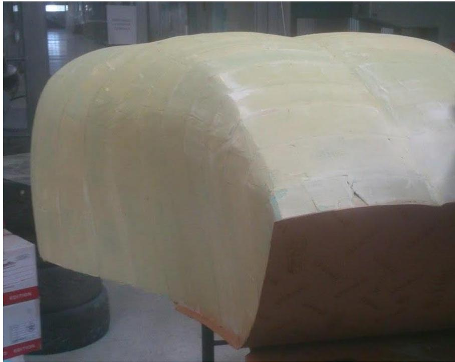
*Figura 75. Molde trasero masillado<sup>95</sup>*
