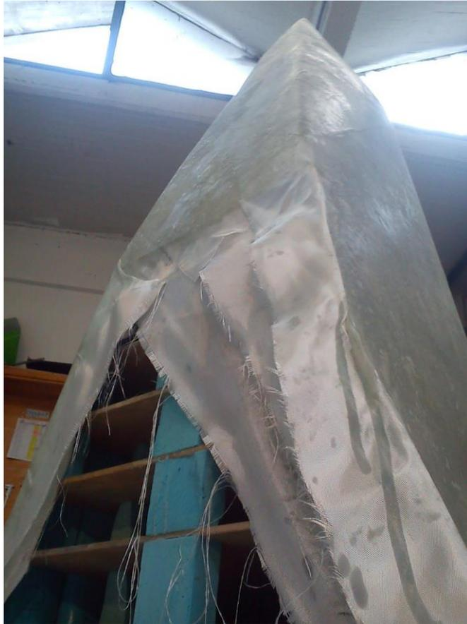
*Figura 62. Laminación parte delantera<sup>82</sup>*
