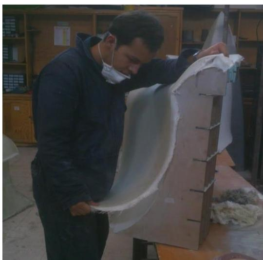
*Figura 72. Desmoldeo de pontones delanteros<sup>92</sup>*
