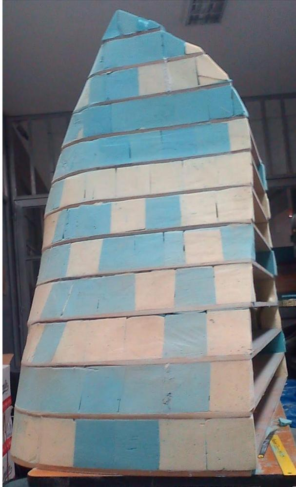
*Figura 74. Parte trasera lijada<sup>94</sup>*
