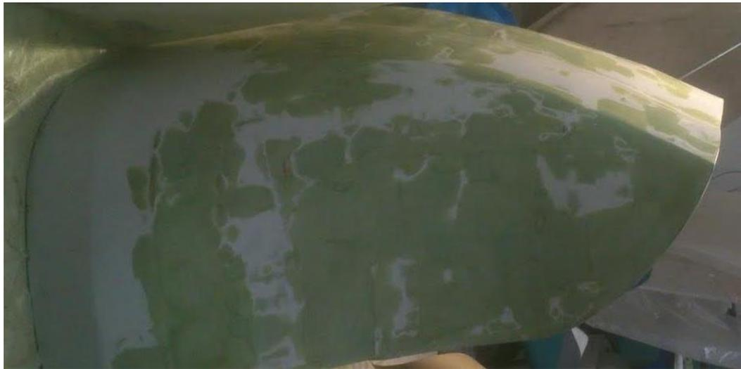
*Figura 76. Molde parte trasera lista para laminación<sup>96</sup>*
