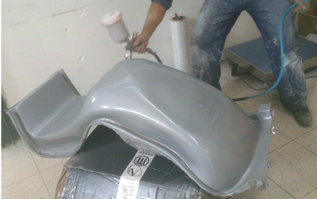
*Figura 45. Proceso de pintura del molde<sup>65</sup>*
