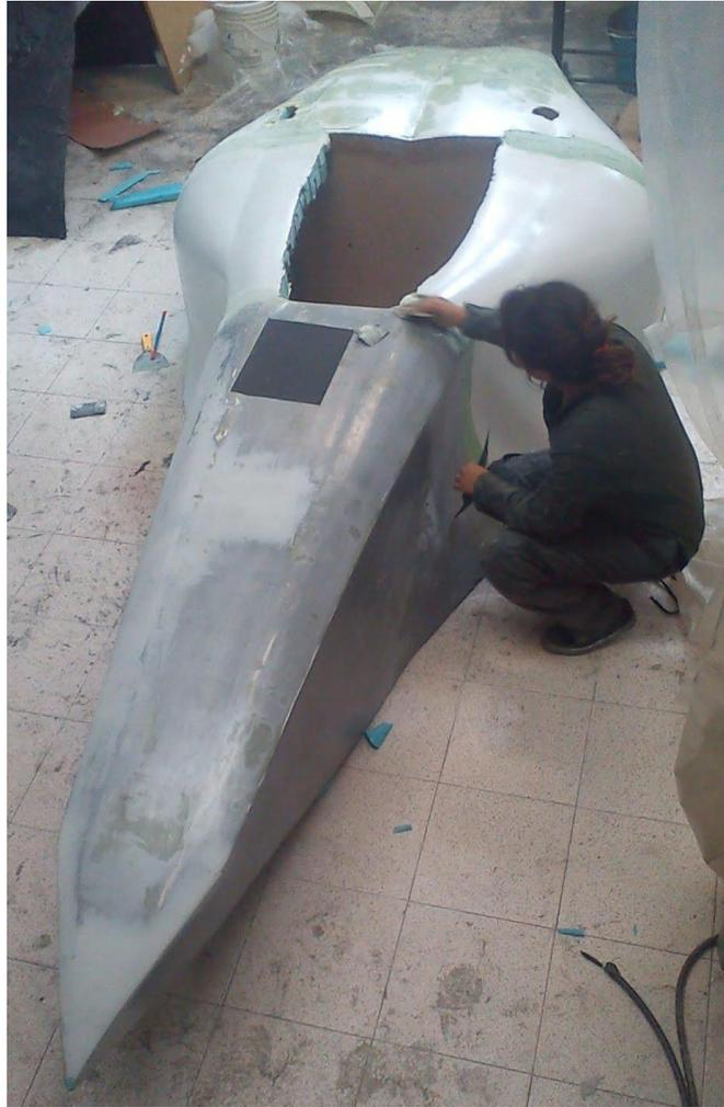
*Figura 83. Unión de moldes<sup>103</sup>*
