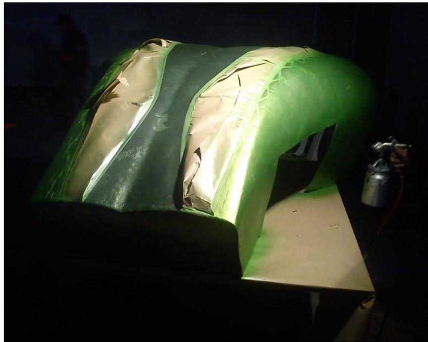
*Figura 89. Proceso de pintura de la parte trasera de la carrocería<sup>109</sup>*
