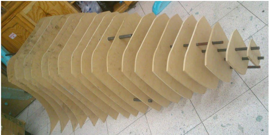
*Figura 56. Matrices de parte delantera unidas con varillas<sup>76</sup>*
