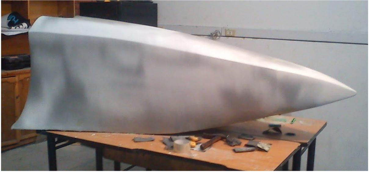
*Figura 61 Molde parte delantera listo para laminar<sup>81</sup>*
