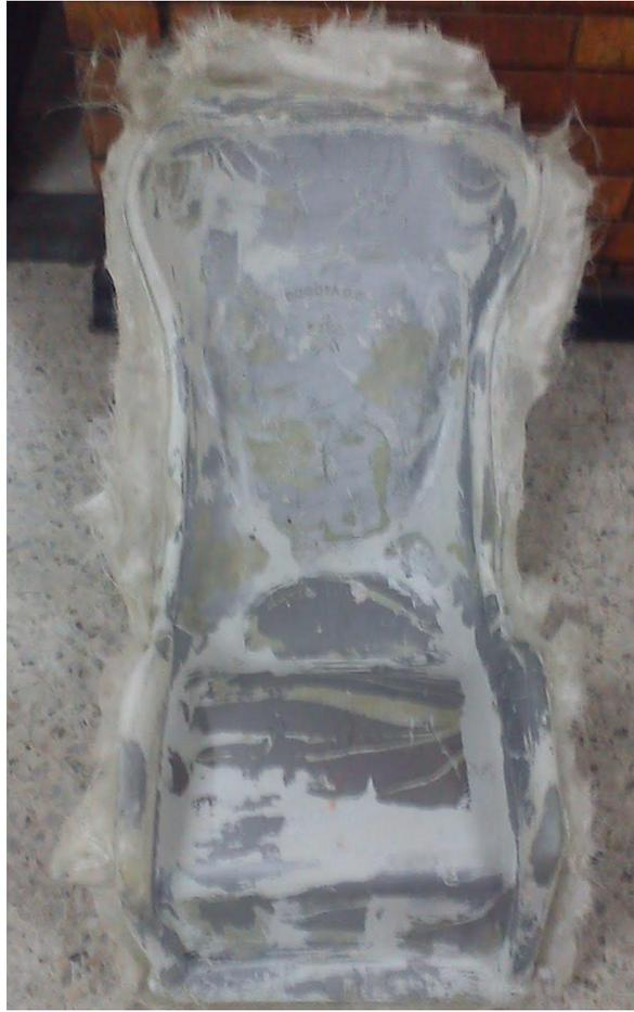
*Figura 51. Silla luego de haber sido desmoldada<sup>71</sup>*
