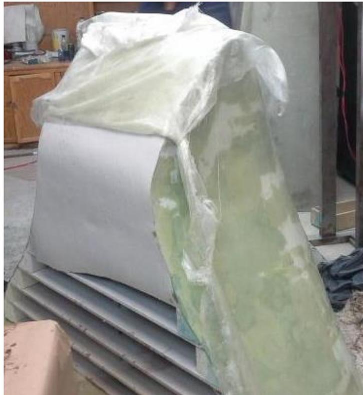
*Figura 78. Remoción de fibra de vidrio por mal uso de resina<sup>98</sup>*
