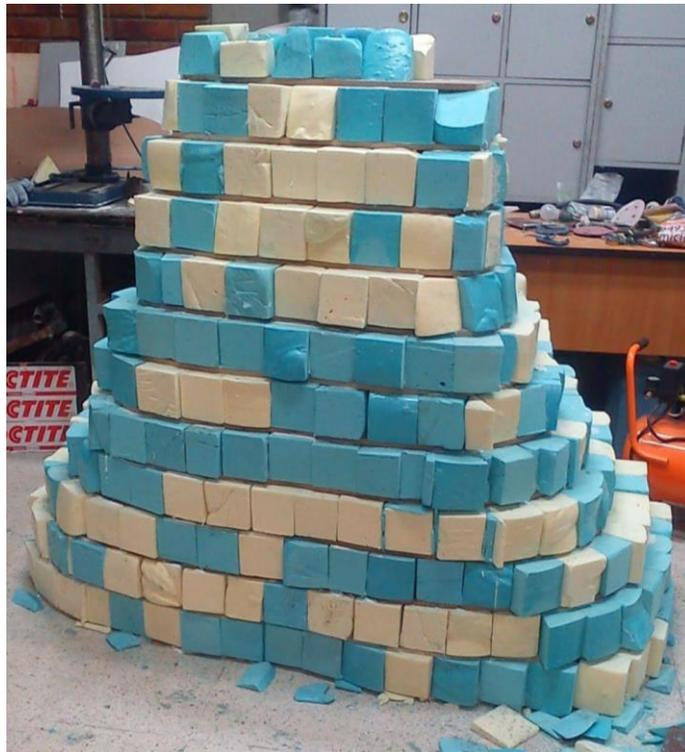
*Figura 73. Molde parte trasera con relleno de poliuretano<sup>93</sup>*
