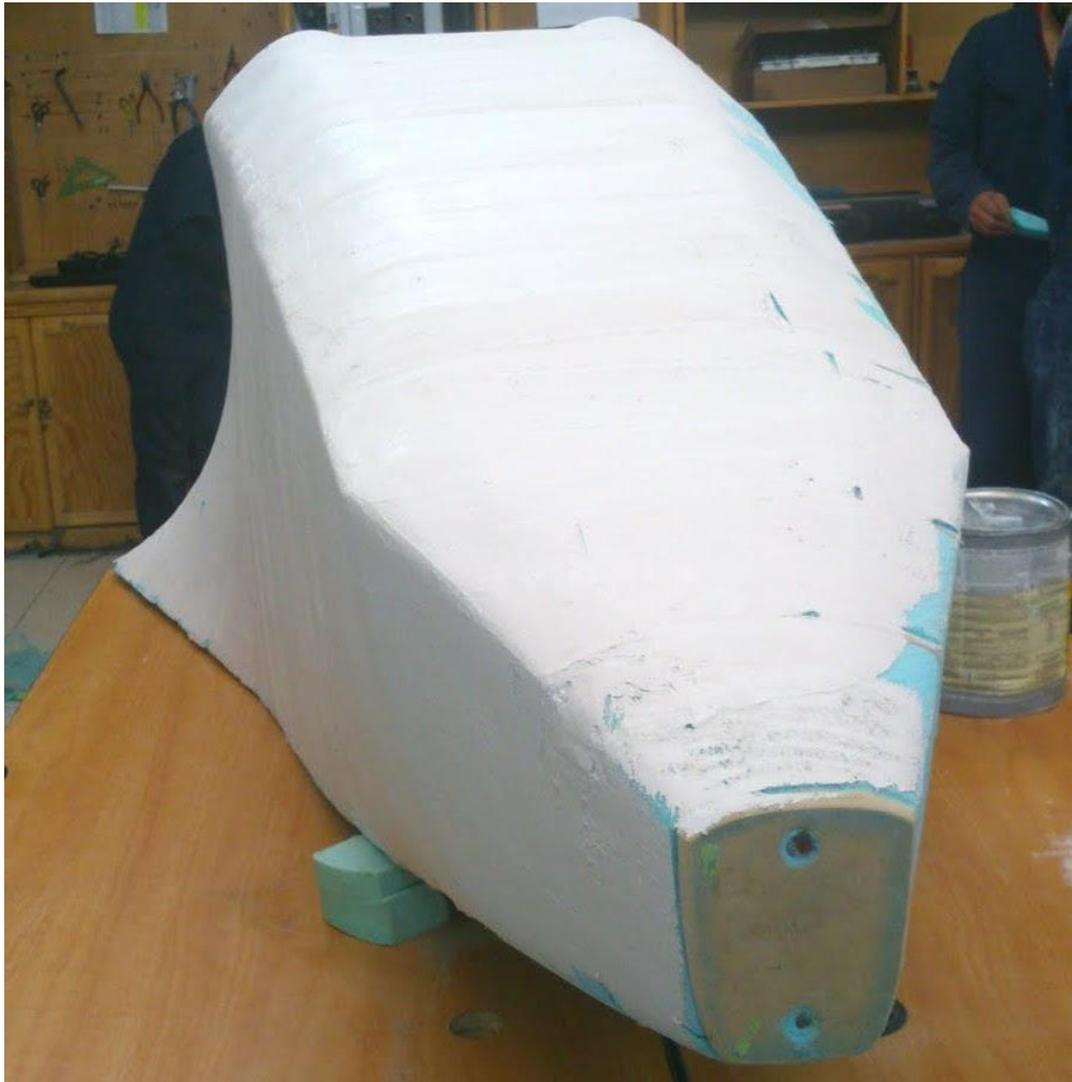
*Figura 60. Masillado de parte delantera<sup>80</sup>*
