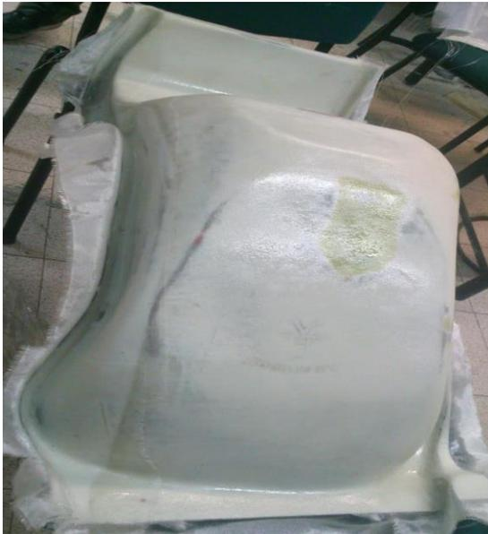
*Figura 49. Primera capa de fibra en la silla<sup>69</sup>*
