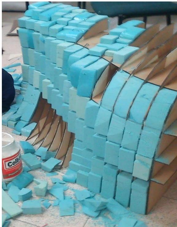
*Figura 67. Molde pontón lateral izquierdo relleno de poliuretano<sup>87</sup>*
