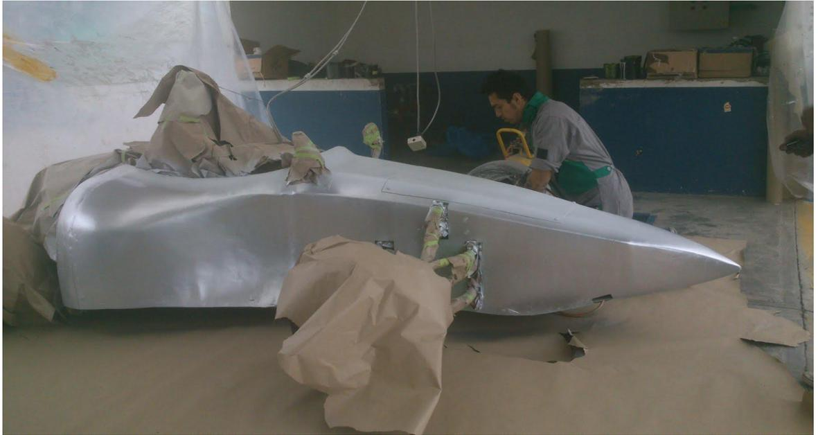
*Figura 86. Base de pintura de la carrocería<sup>106</sup>*
