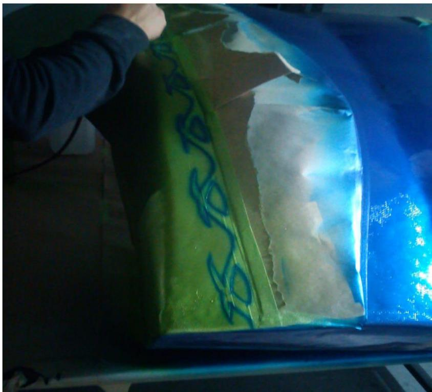
*Figura 90. Ajustes finales de pintura de la parte trasera de la carrocería<sup>110</sup>*
