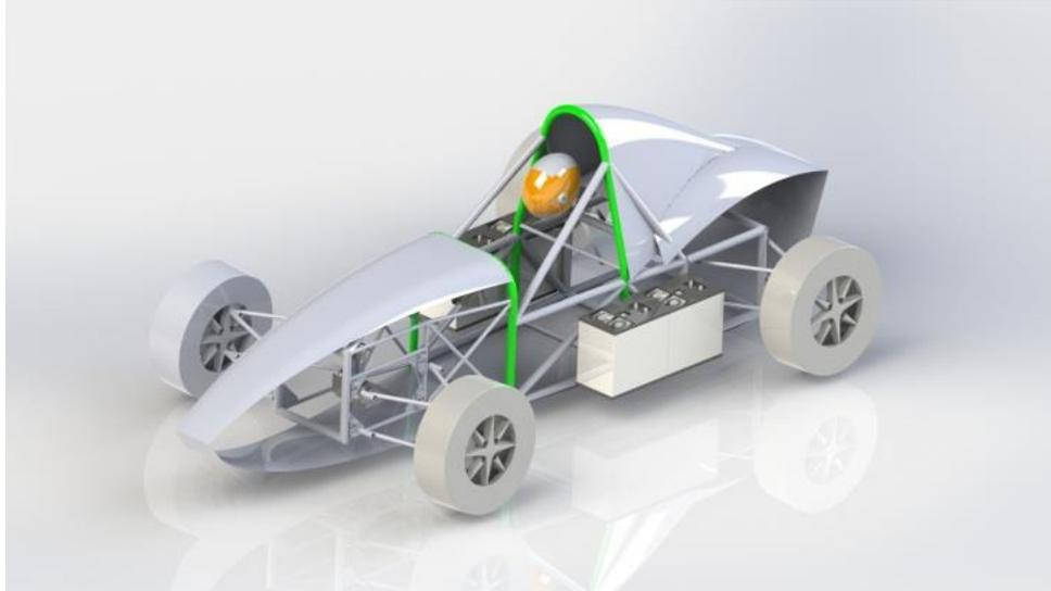
*Figura 7 Adaptación de la carrocería al chasis<sup>24</sup>*
