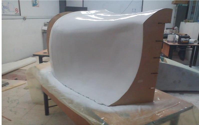
*Figura 68. Molde de pontón lateral derecho<sup>88</sup>*
