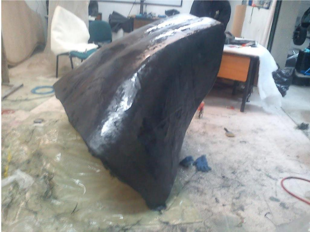
*Figura 79. Laminación de parte trasera con fibra de carbono<sup>99</sup>*
