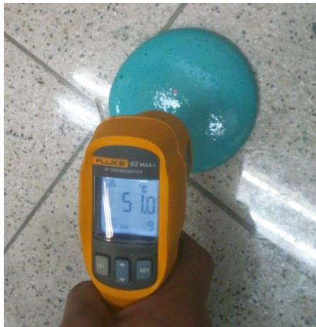
*Figura 23. Temperatura alcanzada por la reacción del poliuretano<sup>42</sup>*
