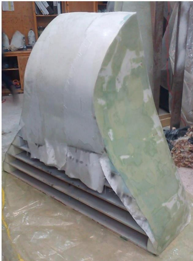
*Figura 77. Molde parte trasera laminado<sup>97</sup>*
