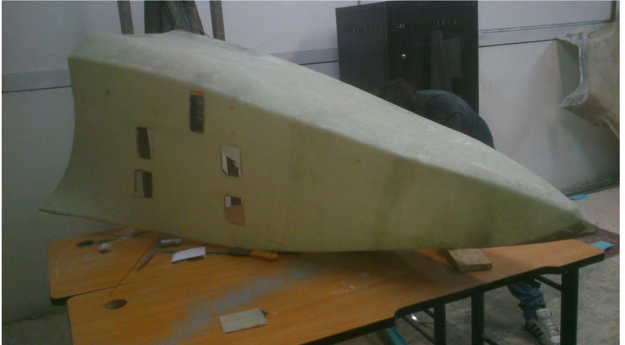
*Figura 81. Cortes para ejes de suspensión en pieza delantera<sup>101</sup>*
