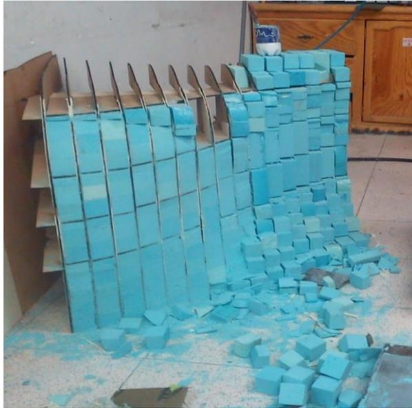
*Figura 66. Molde pontón lateral derecho relleno de poliuretano<sup>86</sup>*
