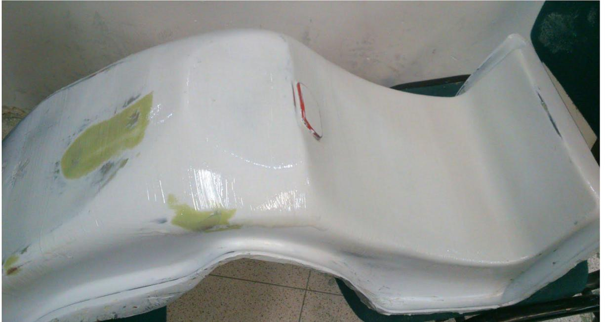
*Figura 46. Molde preparado para laminación.<sup>66</sup>*
