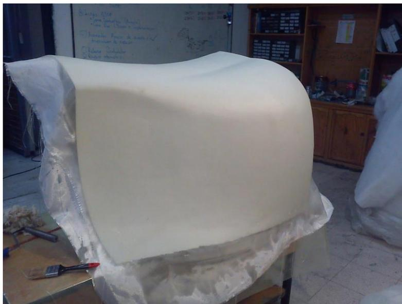
*Figura 71. Pontón lateral izquierdo laminado<sup>91</sup>*
