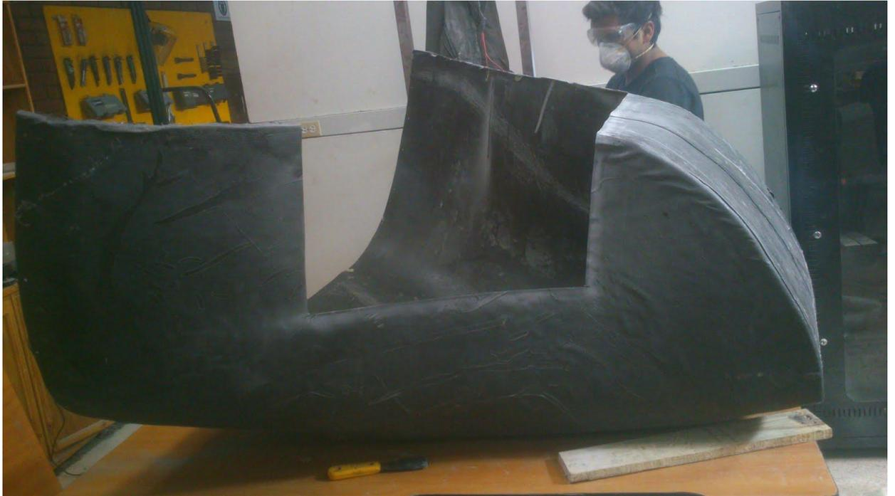
*Figura 82. Cortes para ejes de suspensión en pieza trasera<sup>102</sup>*
