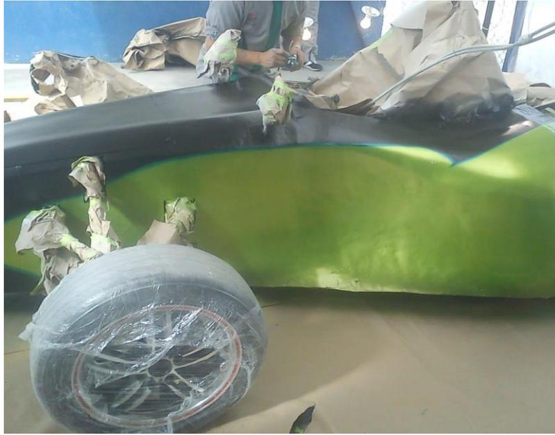
*Figura 88. Pintura carrocería<sup>108</sup>*
