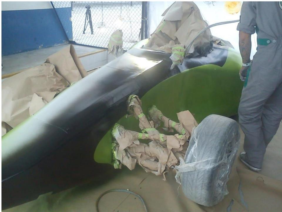
*Figura 87. Pintura carrocería<sup>107</sup>*
