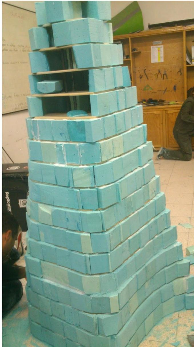
*Figura 58. Molde con relleno de poliuretano<sup>78</sup>*
