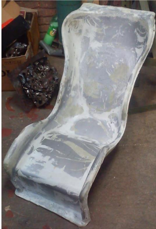
*Figura 52. Corte de fibra sobrante<sup>72</sup>*
