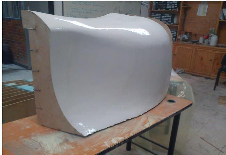
*Figura 69. Molde de pontón lateral izquierdo<sup>89</sup>*
