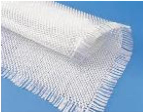
*Figura 2. Fibra de vidrio woven roving.*<sup>10</sup>
