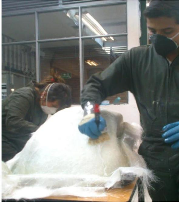
*Figura 48. Impregnación de resina sobre la fibra<sup>68</sup>*
