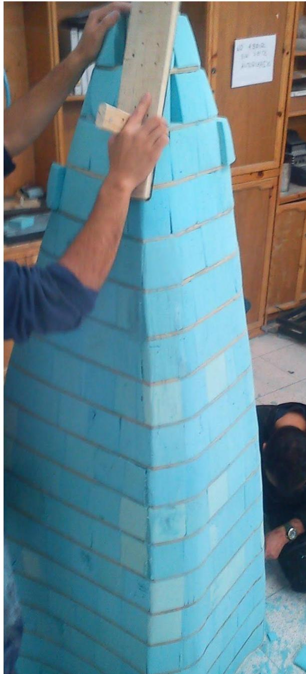
*Figura 59. Lijado molde parte delantera<sup>79</sup>*
