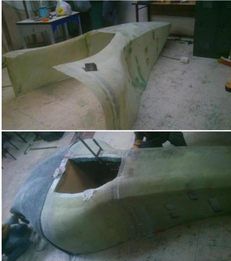
*Figura 84. Unión de pieza delantera con pontones<sup>104</sup>*
