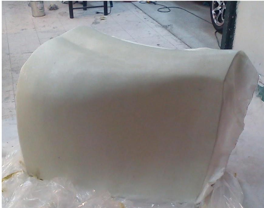
*Figura 70. Pontón lateral derecho laminado<sup>90</sup>*
