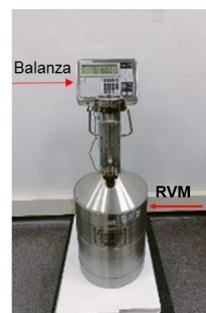
**Figura 1:** Método de medición gravimétrico. Fuente: imagen del laboratorio SIC.
