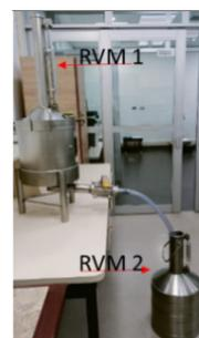
**Figura 2:** Método de medición de transferencia. Fuente: imagen del laboratorio SIC.
