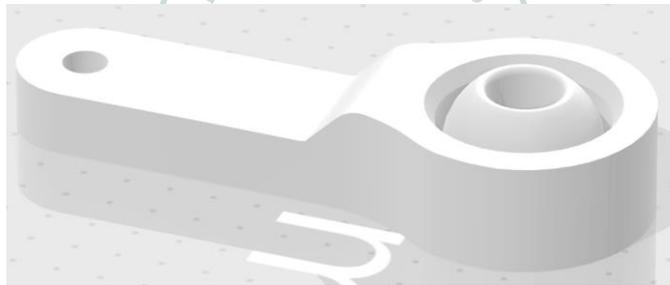
Figura 54. Brazo con Rodamiento.
