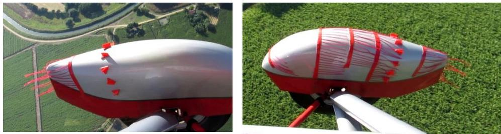
Figura 21. Vuelo # 2 Comportamiento Capa limite con GV instalados
