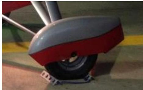
Figura 7. Carenado tipo simétrico
