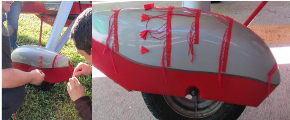
Figura 14. Instalacion generadores de vortice
