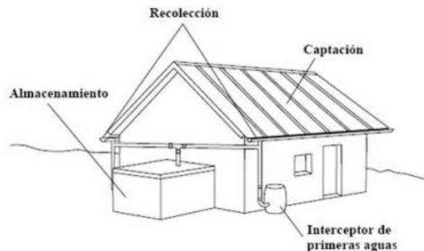
*Ilustración 4 Guía de Diseño para Captación de Agua de Lluvia. CEPIS, 2004.*
