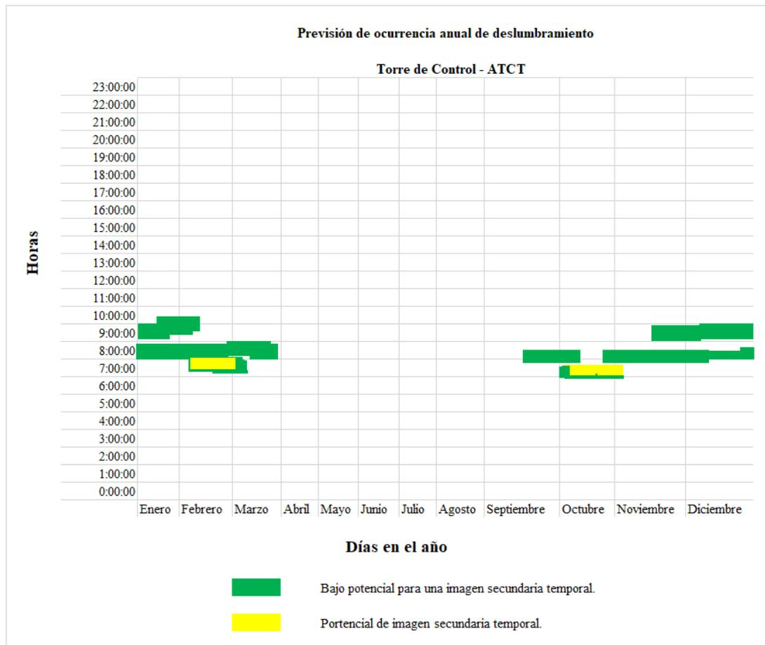
Figura 8.7: Previsión de ocurrencia anual de deslumbramiento en torre de control. Fuente: ForgeSolar
