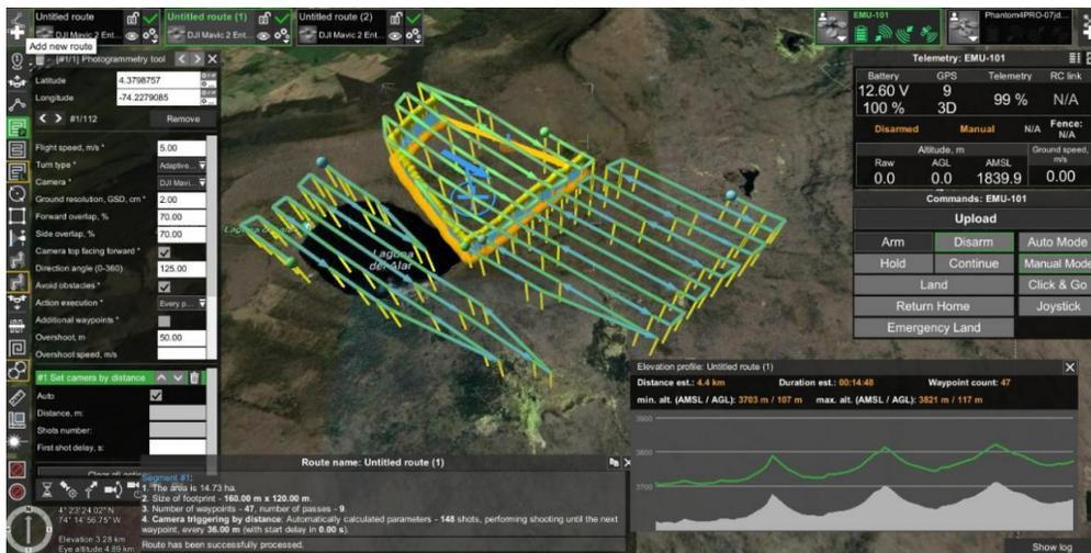
Nota. La figura corresponde al parámetro y vuelo 2 realizados en el programa UGCS (DRONE FLIGHT PLANNING AND CONTROL SOFTWARE by SPH ENGINEERING, s.f.)
