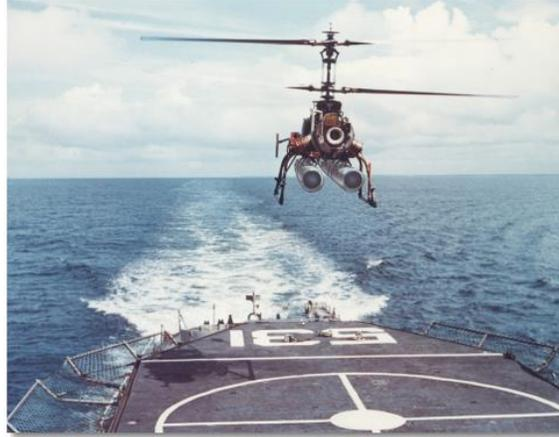
*Figura 2: Helicóptero no tripulado QH-50. [4]*
