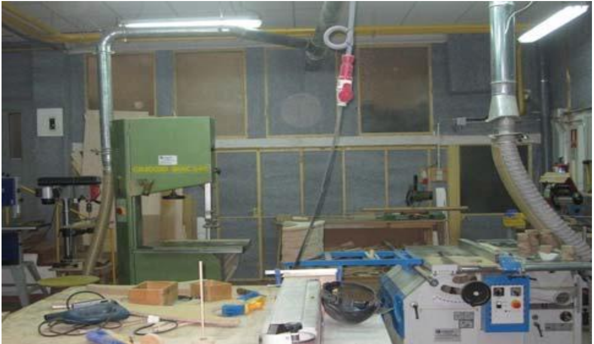
Anexo 9. Taller de ebanistería donde se puede apreciar una de las paredes laterales acondicionada con materiales acústicos.
