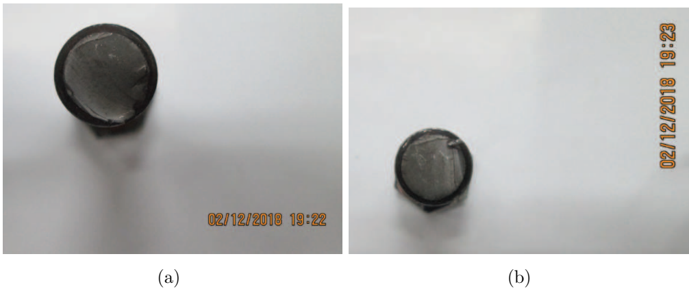
Figura 4-8: a) Fatiga en el perno #1 y b). #2.
