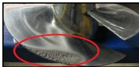
Ilustración 5 Corrosión por Cavitación [15]
