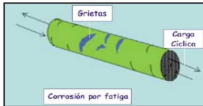
Ilustración 8 Corrosión por Fatiga [18]
