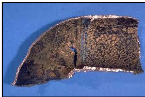
Ilustración 6 Corrosión por Erosión [16]
