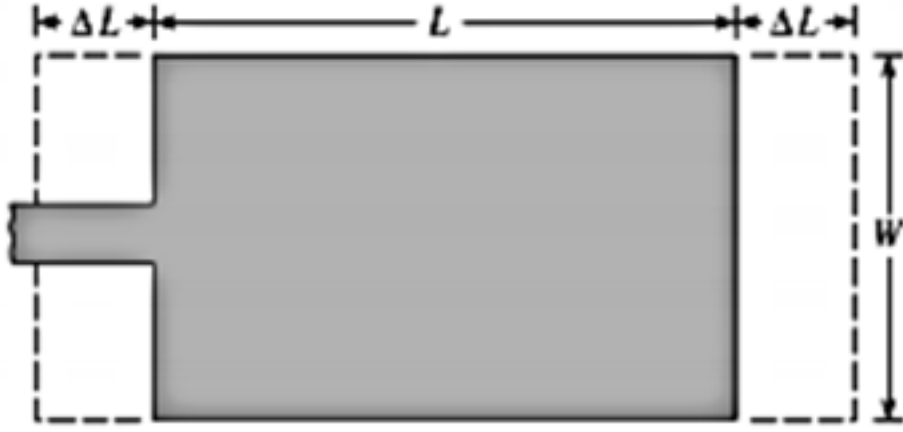
Figura 6: Vista superior de la estructura de la cinta parche de una antena microstrip rectangular.
