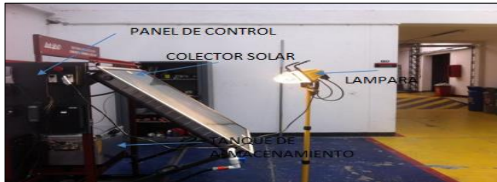
Figura 2. Vista Lateral izquierda del sistema de entrenamiento en energía solar térmica modelo 46121.
