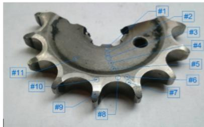
**Figura 4-9:** Toma de muestras de dureza en el cuerpo del Sprocket A.
