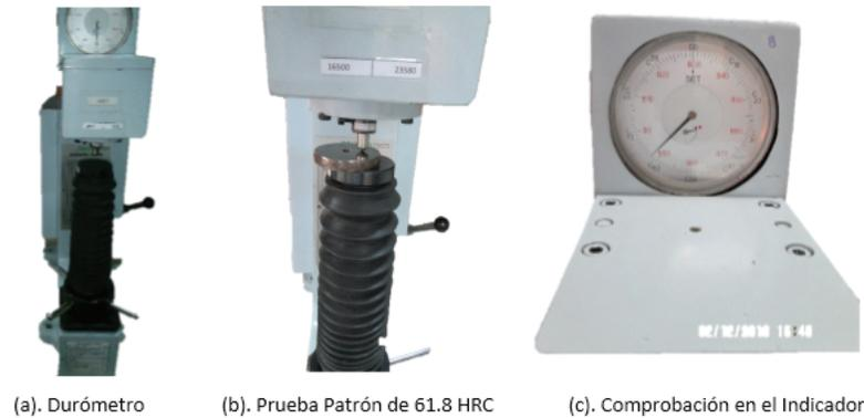
**Figura 4-8:** Equipos y procedimientos utilizados para la medición de la dureza.
