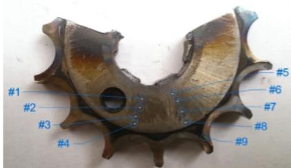
**Figura 4-11:** Toma de muestras de dureza en el cuerpo del Sprocket B.
