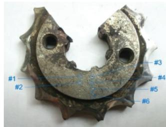
**Figura 4-13:** Toma de muestras de dureza en el cuerpo del Sprocket C.
