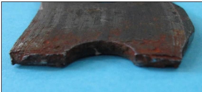
*Ilustración 3*Detalle de la pastilla en la que se puede observar corrosión y una región de fractura
