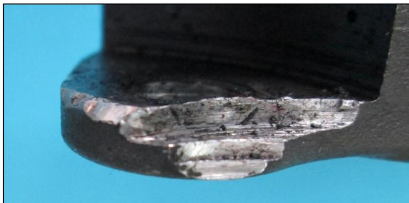
*Ilustración 4*Detalle del balancín en el que se encuentra falla por fatiga.
