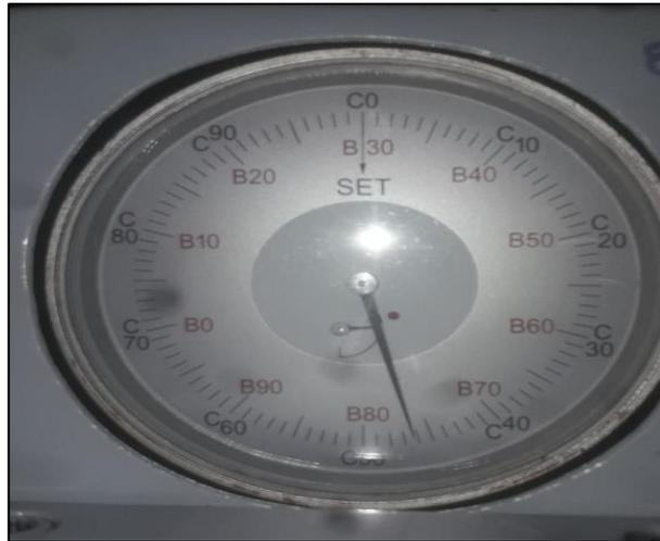
*Ilustración 12 Medición 2) Dureza 46 HRC para la pastilla de freno.*
