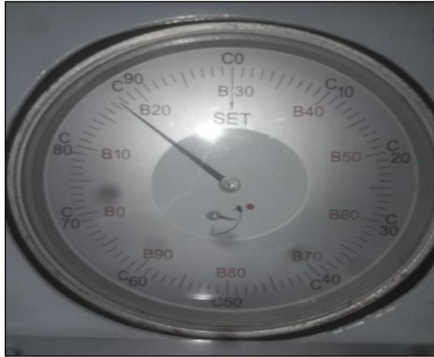
*Ilustración 10 Medición 2) Dureza 87 HRC para el balancín.*
