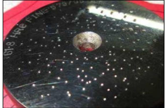
*Ilustración 8 Indicador de dureza Ref.; 61.8 HRC Artefacto de la fundación universitaria los libertadores*
