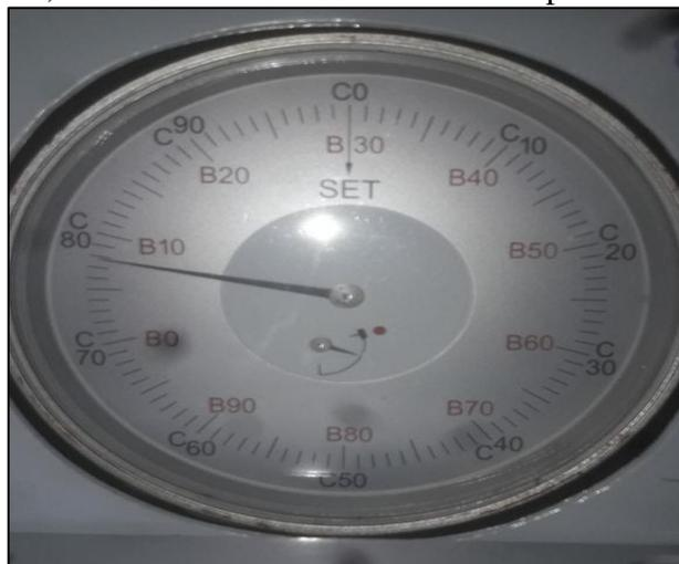
*Ilustración 9 Medición 1) Dureza 79 HRC para el balancín.*
