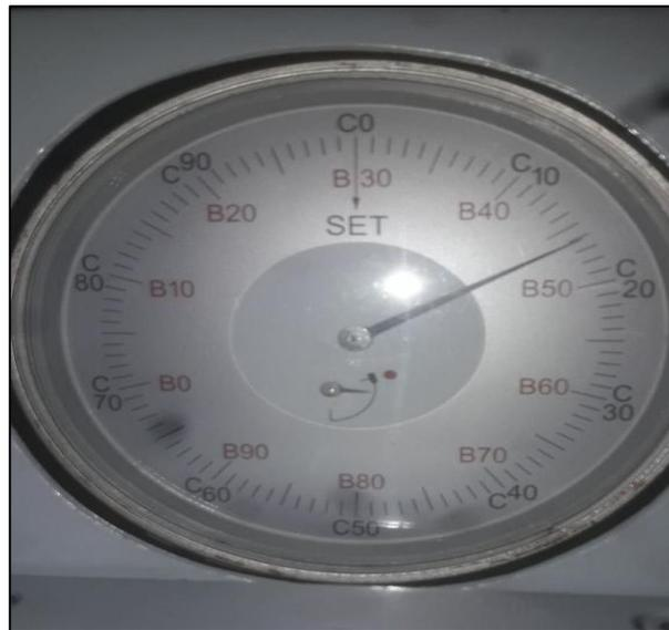
*Ilustración 11 Medición 1) Dureza 16 HRC para la pastilla de freno.*
