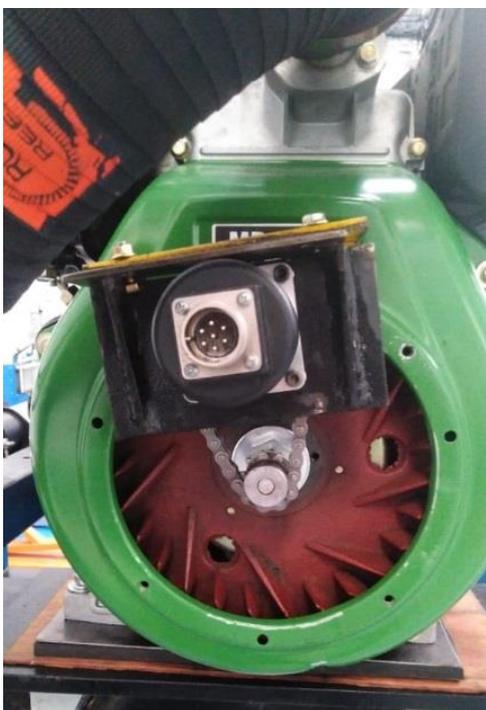
Figura 9.4 Vista del ensamblaje Encoder-motor.
