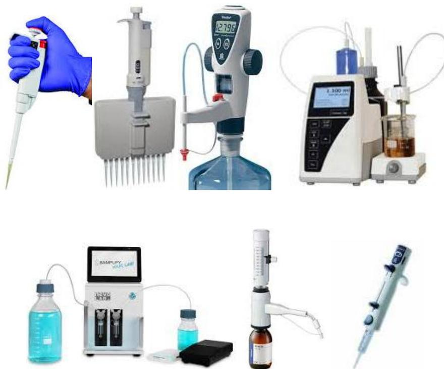
**Ilustración 5.** Imágenes de instrumentos volumétricos operados a pistón, de izquierda a derecha y de arriba hacia abajo: pipeta automática, pipeta multicanal, bureta manual, bureta de motor, dilutores, dispensador de un solo golpe y dispensador de entrega múltiple.
