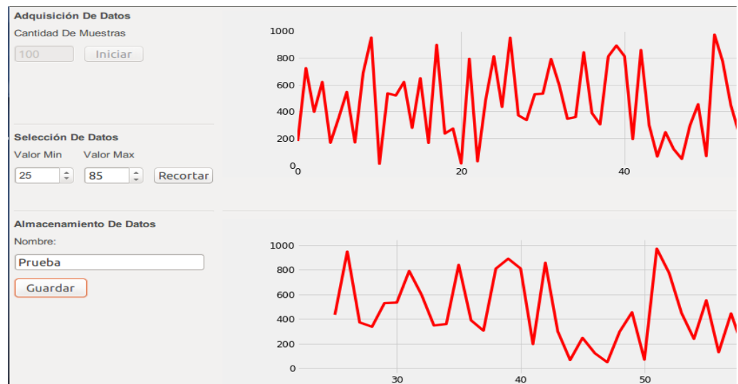
Figura 11: interfaz gráfica donde se obtienen las señales del sensor.
